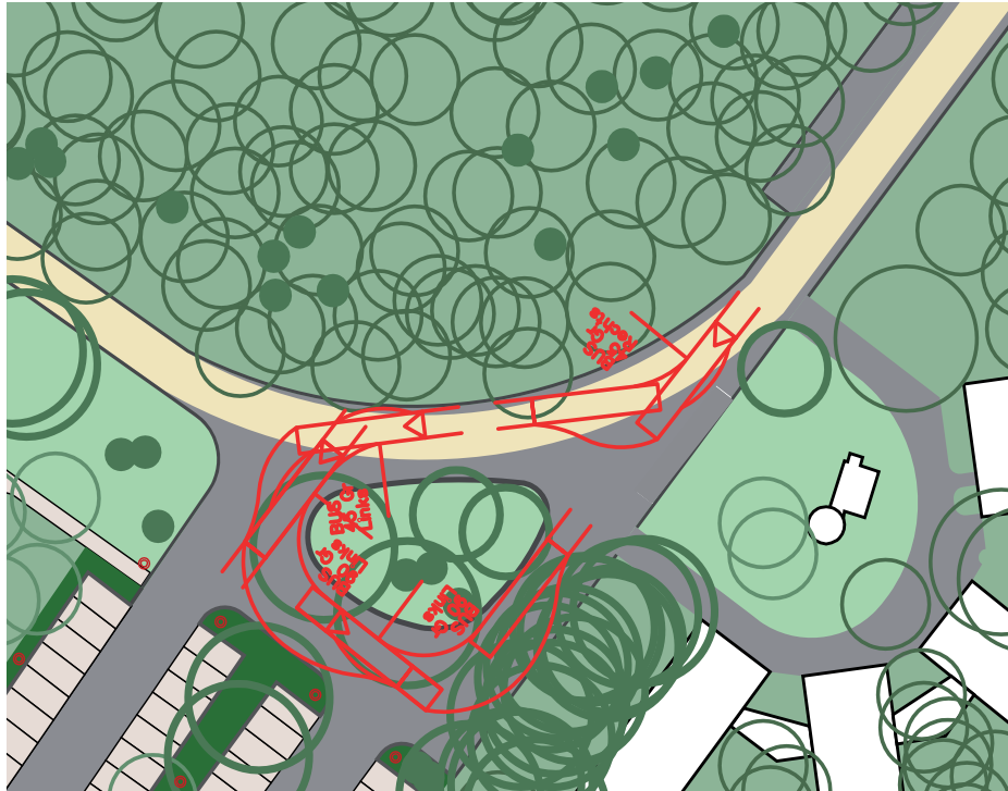
Rijcurves van stadsbus en touringcar 12 meter lengte rondom groen eiland aan einde Bosweg
