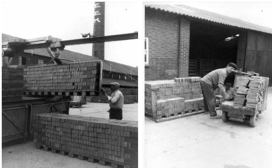
Verwerken Milsbeker strengpers-steen, machinaal en handmatig (bron Stichting Cultuurbehoud Milsbeek)
